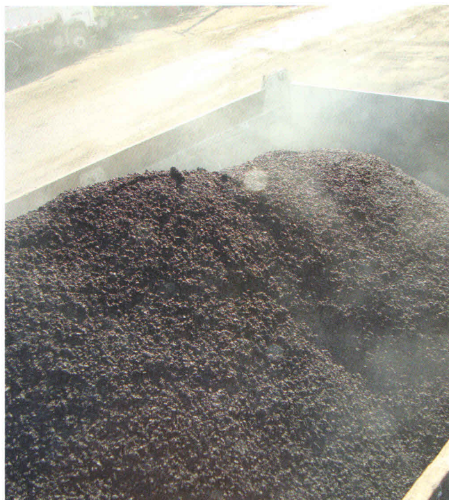
Massa sem WARMIX Temperatura da massa: 158°C
