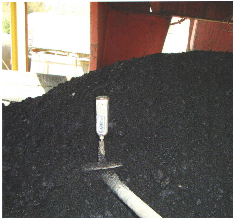
Massa com WARMIX Temperatura da massa: 128°C
